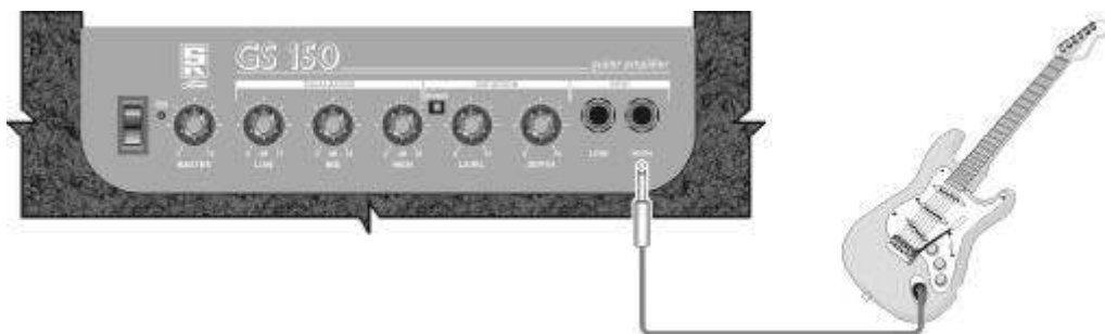
Exemplo 1: Conexão de guitarra à entrada HIGH.
